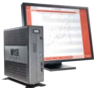
IPS-NetBox.2 ThinClient con software "Comunicazione & tracciabilità" per 1 macchina
