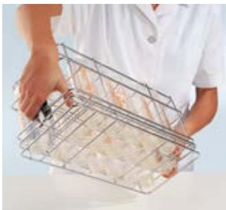
2. Il container viene chiuso con il coperchio (griglia). Il container viene quindi ruotato di 180° (apertura biberon rivolta verso il basso) e introdotto nel termodisinfettore.
