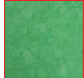
Materialangriff der natur-/farbeloxierten Aluminiumoberfläche bei Containern. Ursache: unzulässig hohe alkalische Waschlösung
