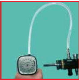
Manueller Dichtetest bei einem flexiblen Endoskop
