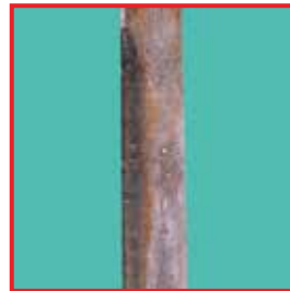
Knochenstanze, Gleitfläche des Schiebeteiles zeigt Reibkorrosionserscheinungen
