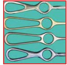
Titanoxidverfärbungen treten vorrangig bei glänzender Oberflächenbeschaffenheit flächig, gelbbraun bis blauviolett, teils schimmernd ausgeprägt, in der Spülkammer oder auf der gesamten Instrumentenoberfläche bei der maschinellen Reinigung auf.
