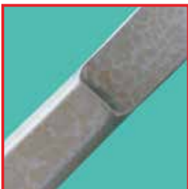
Fleckenmuster durch Verunreinigungen im Dampfkondensat
