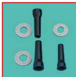
Rechts: Aufgequollene Dichtungen als Folge von nicht gezielt aufgebrachtem Instrumentenöl. Links: Neue Dichtungen
