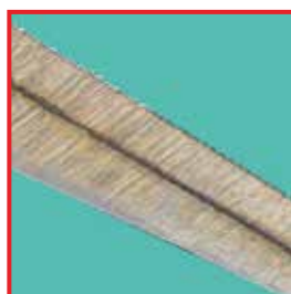
Beizangriff der Lotnähte. Bei Hartmetall-Scheren, Hartmetall-Pinzetten- und Nadelhaltern Ursache: Säureangriff wegen Überdosierung der Neutralisationschemie oder der Anwendung von Grundreinigern.
