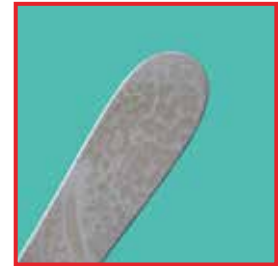
Typische Silikatverfärbungen treten, unabhängig von der Oberflächenbeschaffenheit, flächig, gelbbraun bis blauviolett im Reinigungs-Desinfektions-Prozess oder fleckenartig, tröpfchenförmig und mit ausgeprägtem kondensationsfleckenartigem Erscheinungsbild im Dampfsterilisationsprozess auf.
