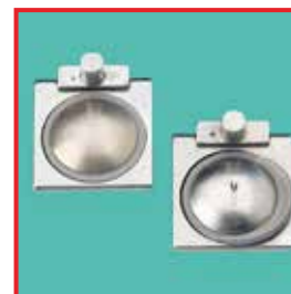
Rechts: Undichtetes Klappenventil eines Trokars durch Aufquellung der Dichtung als Folge von Ölkontakt. Links: Neues Klappenventil
