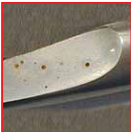
Chloridinduzierte Lochkorrosion auf dem Instrument.
