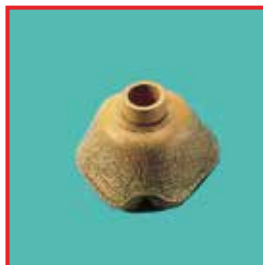
Alterungsrisse an einer Atemmaske
