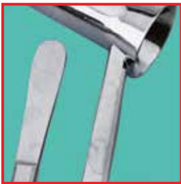
Verfleckungen auf Grund hohen Salzgehalts im Nachspülwasser
