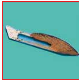
Materialangriff der Klingenoberfläche wegen Feuchte. Ursache: Werkstoffzusammensetzung, Normalstahl da Einmalprodukt.
