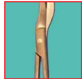
Beizangriff der Instrumentenoberfläche. Ursache: Säureangriff wegen Überdosierung.
