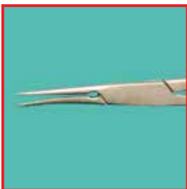
Verformung durch unsachgemäße Handhabung
