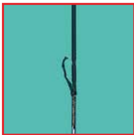
Beschädigte Isolierung an einem HF-Instrument
