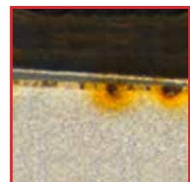
Beizangriff der Lotnähte. Bei Hartmetall-Scheren, Hartmetall-Pinzetten- und Nadelhaltern Ursache: Säureangriff wegen Überdosierung der Neutralisationschemie oder der Anwendung von Grundreinigern.
