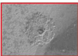
Rasterelektronenmikroskop-Aufnahme, chloridinduzierte Lochkorrosion
