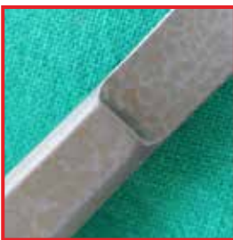
Fleckenmuster, verursacht durch Kieselsäure im Dampfkondensat.
