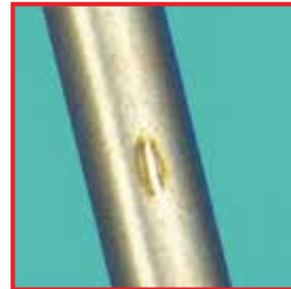
Beispiele für Spaltkorrosion durch Instrumentenkontakt
