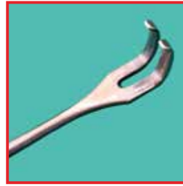
Titanoxidverfärbungen treten vorrangig bei glänzender Oberflächenbeschaffenheit flächig, gelbbraun bis blauviolett, teils schimmernd ausgeprägt, in der Spülkammer oder auf der gesamten Instrumentenoberfläche bei der maschinellen Reinigung auf.
