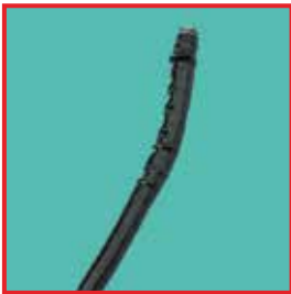
Aufquellung am Distalende eines Fiberskops
