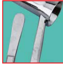
Folge: Instrumente mit Kalkrückständen
