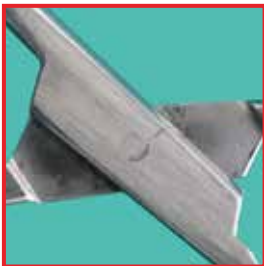
Spannungsrisse im Gewindebereich einer Schere
