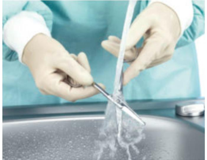
Abspülen des Testinstruments und Prüfung auf Farbrückstände.
