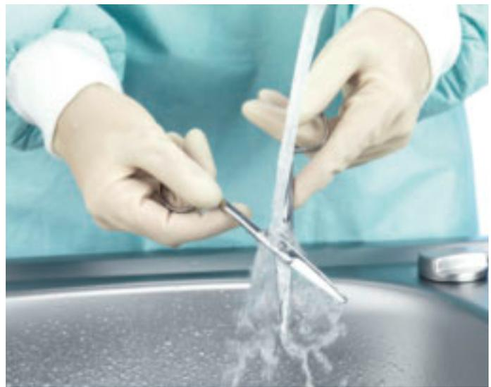
Abspülen des Testinstruments und Prüfung auf Farbrückstände.
