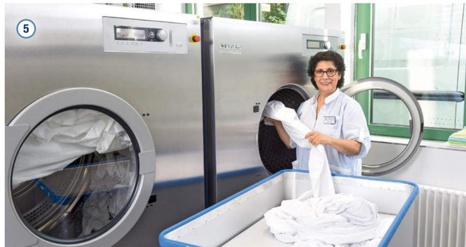
Effizienter Wäschekreislauf: Auf der unreinen Seite (1) werden die Durchlade- und Frontlademaschinen von Molly Gungunyani (2) und Rita Jerosch (4) mit Schmutzwäsche beladen, anschließend auf der reinen Seite getrocknet (3 und 5). Die Bewohnerwäsche wird dann auf einer professionellen Handbügelstation (6, Seite 10) gefiniert, die Flachwäsche gemangelt und gelegt.
