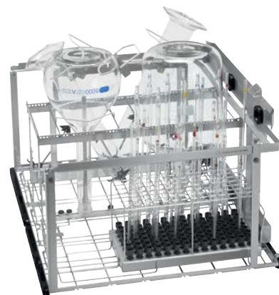
A 503 s 1x A 612, 1x A 623, 1x A 613 • 98 pozic pro pipety • 4 měrné válce max. 2 l • Modul pro velké laboratorní lahve např. 2 lahve á 10 l
