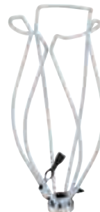
E 354 Aretace výškově nastavitelná, pro optimální umístění laboratorního skla na trysce
