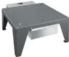
APCL 086 Sokl otevřený, se skříňkou filtru na zachycení vláken, výška 30 cm, pro odfiltrování vláken a velkých částic z pracího roztoku. • v/š/h: 30,00 cm – 60,24 cm – 86,00 cm
