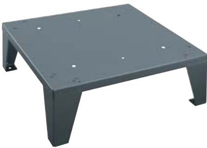
APWM 033 Sokl otevřený, výška 30 cm, pro ergonomické plnění a vyprazdňování praček. • v/š/h: 29,00 cm – 77,00 cm – 77,00 cm
