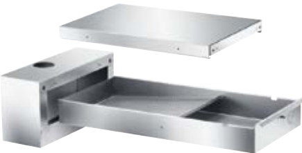
APCL 021 Zásuvka filtru na zachycení vláken z nerez oceli, pro odfiltrování vláken a velkých částic z pracího roztoku. • Pro montáž na vhodný sokl • Odnímatelný pro rychlé a snadné čištění. • Snadno vyjímatelý filtr na uvolněná vlákna z nerezové oceli • Objem 24 litrů • Průměr přípojovacího hrdla dozadu 70 mm • v/š/h: 25,00 cm – 49,85 cm – 86,00 cm
