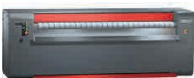
Figura: mangano D500, lato anteriore (introduzione della biancheria)
