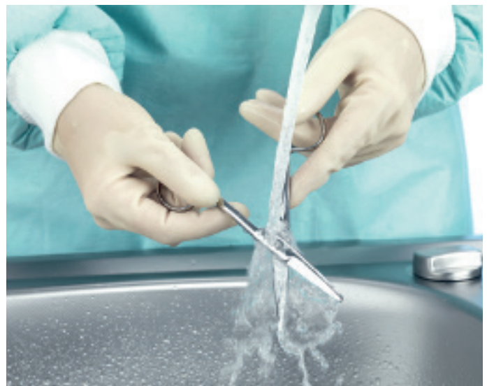
Risciacquo dello strumento di test e controllo della presenza di residui di colore.
