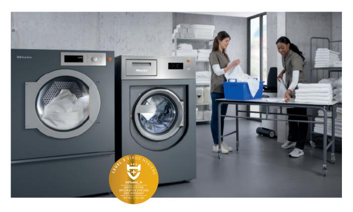
Auch nach dem Waschen tragen ausgewählte Massnahmen zu hygienisch hohem Niveau der aufbereiteten Wäsche bei. Hierzu zählt als Erstes die maschinelle Trocknung der Textilien. Wurde die Wäsche zuvor gründlich von Mikroorganismen befreit, verhindert eine vollständige Trocknung das Wiederanwachsen dieser. Eine Voraussetzung ist die korrekte Beladungsmenge – bei einer zu grossen Wäschemenge kann eine vollständige Trocknung nicht ausreichend sichergestellt werden.
