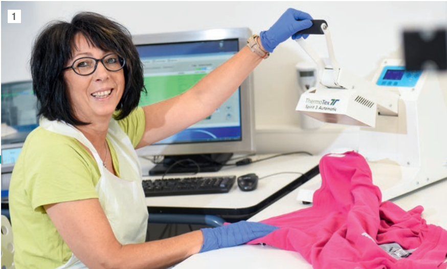
So spart man Zeit: Andrea Wallasch (1) patcht neue Textilien mit dem Chip. Mit der digitalen RFID-Technik von Thermotex kann der Weg eines Textils nachvollzogen werden. Zum Beispiel, wenn ein Shirt gefinisht ist (2). Angelika Wetzel (3) benutzt die Bügelpuppe von Veit, um ein Hemd zu finishen – das geht schneller als mit dem Handbügeln.
