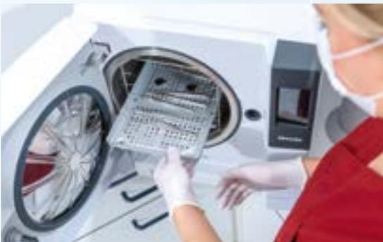
Der Kleinst sterilisator Cube X fällt zuerst durch sein kompaktes, platzsparendes Design auf. Kommen die zahnmedizinischen Instrumente hier an, auf der „reinen Seite“ des Kreislaufes, werden diese je nach Instrumententyp verpackt oder unverpackt auf einem der Trays des Sterilisators platziert, fertig, um ein Bad im Wasserdampf bei 134 °C zu nehmen.
