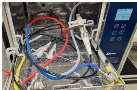
Abb. 3: Spypach „Classic“ Endoskopdummy mit Datenloggern EBI12 zur Messung der Drücke und Temperaturen im nachgebildeten Endoskop.
