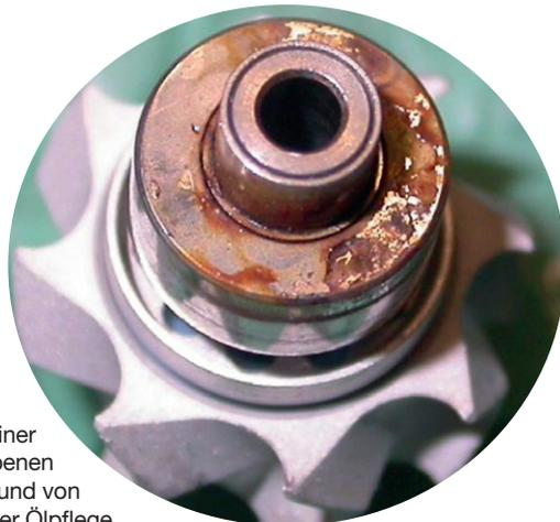
**Abb. 3:** Rotor einer Turbine mit rostfarbenen Belägen aufgrund von mangelnder Ölpflege.
