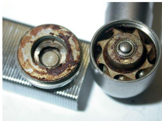
Abb. 2: Turbine mit abmontiertem Druckknopf – Rotor mit Restanschmutzung.
