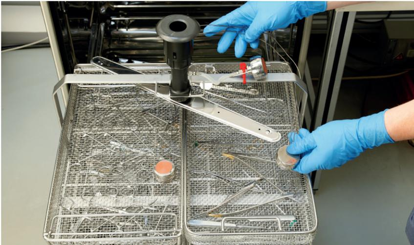
Abb 2: Spüldruckmessung während der Prozessvalidierung im RDG.
