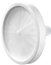
APST 007 Mikrofeinfilter zum Filtern von bakteriologischen Kontaminanten aus der Raumluft. • Einfach auswechselbar an der Vorderseite der Sterilisatoren • Erforderlicher Austausch nach 400 Sterilisationszyklen Mat.-Nr. 11377360
