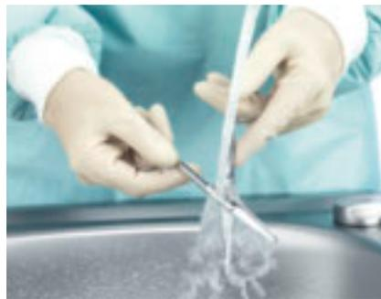
Abspülen des Testinstruments und Prüfung auf Farbrückstände.
