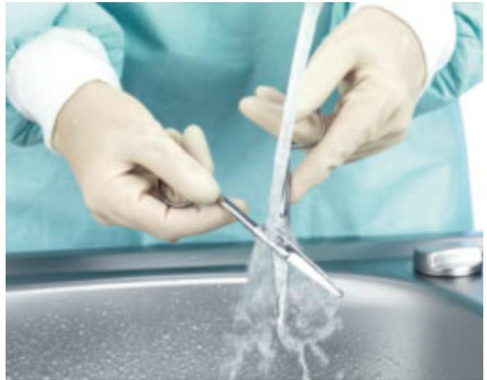
Abspülen des Testinstruments und Prüfung auf Farbrückstände.
