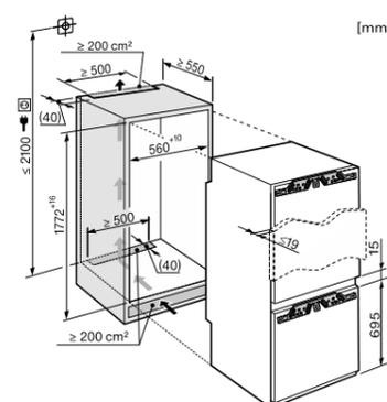
KFN 7734 F / KFN 7734 D / KFN 7744 E / KFN 7764 D
