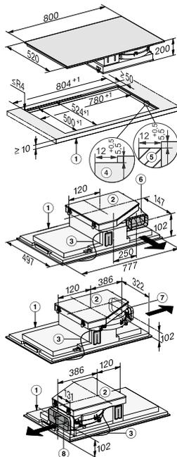
1) Evacuation ou recyclage. Pour les installations en recyclage, penser à commander les accessoires nécessaires : Kit de recyclage DUU 1000-2 et filtre à charbon DKF 1000-R.
