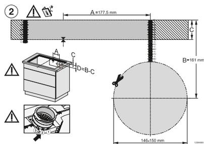
Instalación en recirculación canalizando la salida de aire a zócalo
