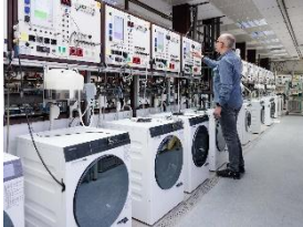
Foto 1: Dauertests im Labor: Miele testet Gerätemodelle auf eine Lebensdauer von bis zu 20 Jahren. (Foto: Miele)
