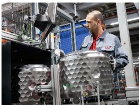
Foto 5: Ein Miele Mitarbeiter prüft die «InfinityCare»-Waschtrommel, die weltweit erste rippenlose Trommel. (Foto: Miele)
