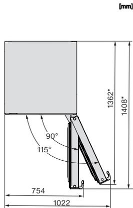
FN4778C, FN4748C, FN4748D, FN4778D, top view
