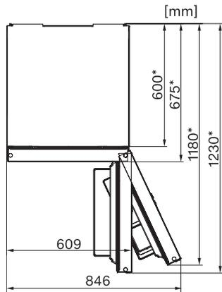
KF29233, KFN29233, KFN29433, KF29283, KFN29283, KFN29483, top view, (sketch) (\*footnote)
