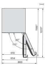
KFN4777CD, KFN4797DD, KFN4797CD, KFN4799DDE, KFN4795DD, KFN4795CD, KFN4795BD, top view (footnote\*)
