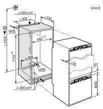
KDN37232iD, KF37233iD, KFN37432iD, KFN37452iDE, KFNS37432iD, KFN37433iD, KFN37282iD, KFN37682iD (installatin drawings)
