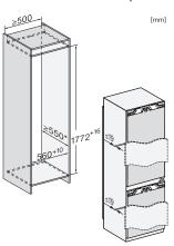
KFN7734C, KFN7734F, KFN7734D, KFN7764D, KFN7785D, KFN7744E, KFN7774D, built-in (footnote\*) (installation drawings)
