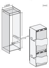
KFN7734C, KFN7734F, KFN7734D, KFN7764D, KFN7785D, KFN7744E, KFN7774D, Einbau (Fußnote\*) (Skizze)
