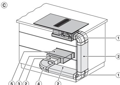
KMDA 7633, KMDA 7634, KMDA 7476 - Einbauvariante
