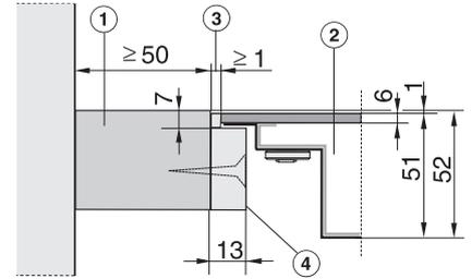
KM 6367 PowerFlex (Skizze) – Einbau in Naturstein-Arbeitsplatten
