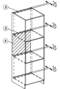
1) Ansicht von vorne, 2) Netzanschlussleitung, L=2.000 mm, 3) Lüftungsausschnitt min. 180 cm<sup>2</sup>, 4) kein Anschluss in diesem Bereich
