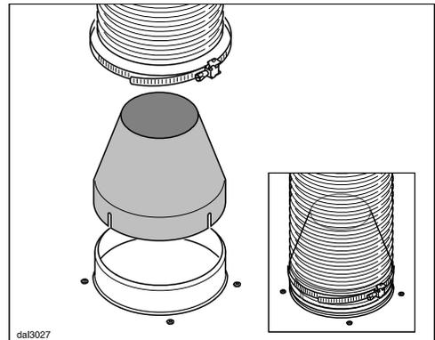
Si desea reducir el impacto medioambiental del sistema de ventilación al limitar la generación de pies cúbicos por minuto (CFM), puede instalar el collar reductor. Reduce el flujo de aire a menos de 400 CFM. Revise los códigos de construcción de su localidad para conocer los requisitos de CFM máximos.
