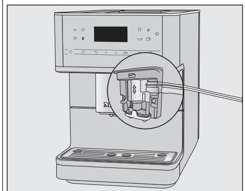
**Повідомлення:** Після використання ретельно промийте трубку для подавання молока під проточною водою.
