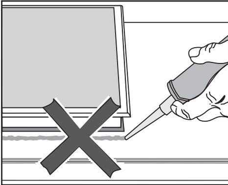
⚠ Schäden durch falschen Einbau. Kochfeld und Arbeitsplatte können bei einem eventuell erforderlichen Ausbau des Kochfeldes beschädigt werden, wenn Sie das Kochfeld mit Fugendichtungsmittel abdichten. Verwenden Sie kein Fugendichtungsmittel zwischen Kochfeld und Arbeitsplatte. Die Dichtung unter dem Rand des Kochfeldes gewährleistet eine ausreichende Abdichtung zur Arbeitsplatte.
