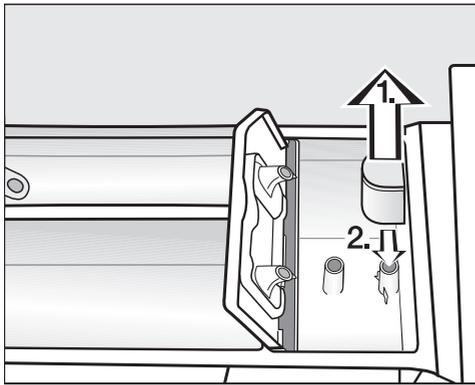
1. Puxe o sifão para fora do compartimento e lave-o debaixo de água quente corrente. Limpe igualmente o tubo onde o sifão se encaixa.
