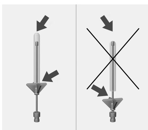
Falls die Spitze der Düse am Glasboden anliegt, die Kunststoffstütze nach oben verschieben.
