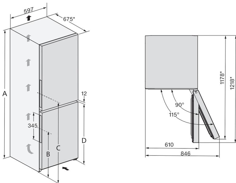
\* Dimenzije bez montiranih zidnih odstoynika. Ukoliko se koriste zidni odstoynici, povecava se dubina uređaja za 15 mm.
