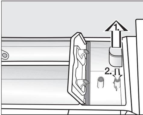
1. Retirez le siphon du compartiment ☼ et nettoyez-le à l'eau chaude. Nettoyez également le tube sur lequel le siphon est fixé.
