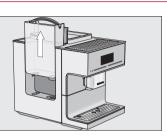
Füllen Sie kaltes, frisches Trinkwasser bis zur Markierung "max." n den Wassertank.
