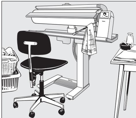
Assicurarsi che il mangano sia in posizione orizzontale per garantire una fuoriuscita omogenea del vapore. Assicurarsi che abbia una stabilità sufficiente affinché non si sposti.
