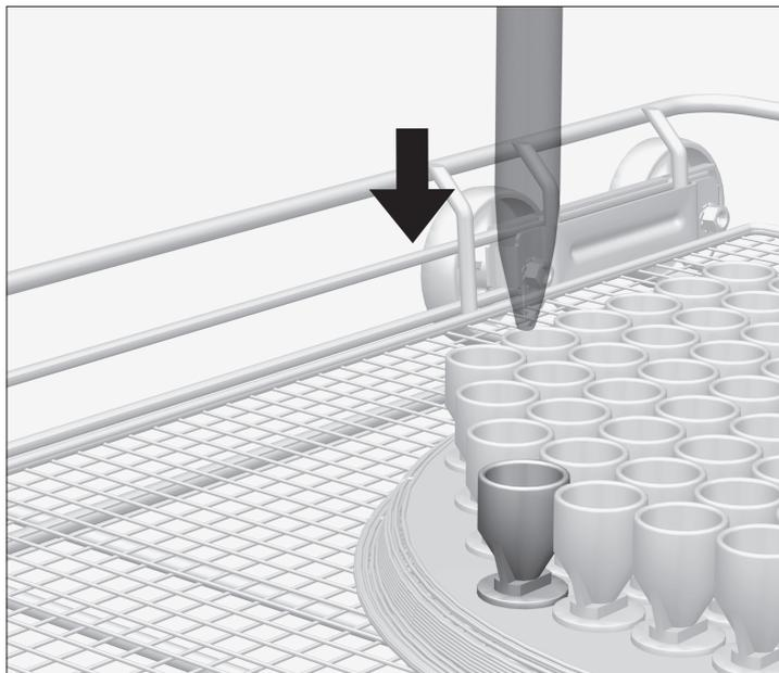
■ Die Pipetten mit der Spitze nach unten durch das Haltegitter in einen Aufnahmetrichter stellen.
