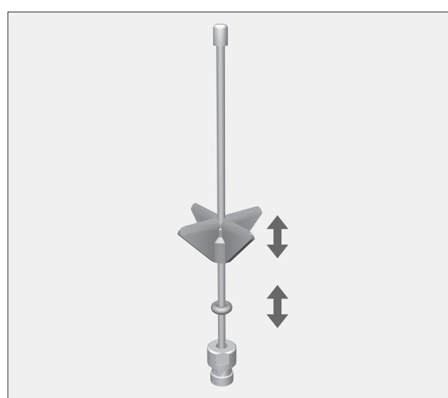
Per non dover continuamente adattare l'altezza dei sostegni in plastica, si consiglia di utilizzare il modulo iniettore sempre per vetreria di laboratorio dello stesso tipo e della stessa dimensione.
