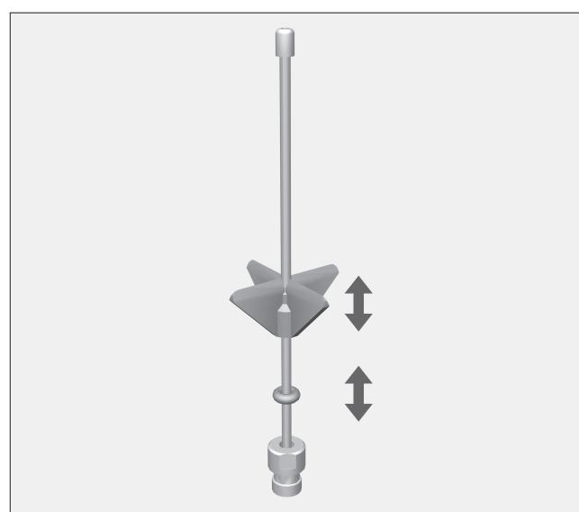
Afin de n'adapter la hauteur des supports en plastique qu'une seule fois, le module d'injection pour verrerie de laboratoire ne devrait être utilisé que pour des verres de même type et de même taille.
