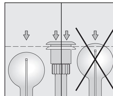
Gläser dürfen nicht über das Zuflussrohr (mit heruntergedrücktem Adapter für Wasserversorgung) hinausragen.
