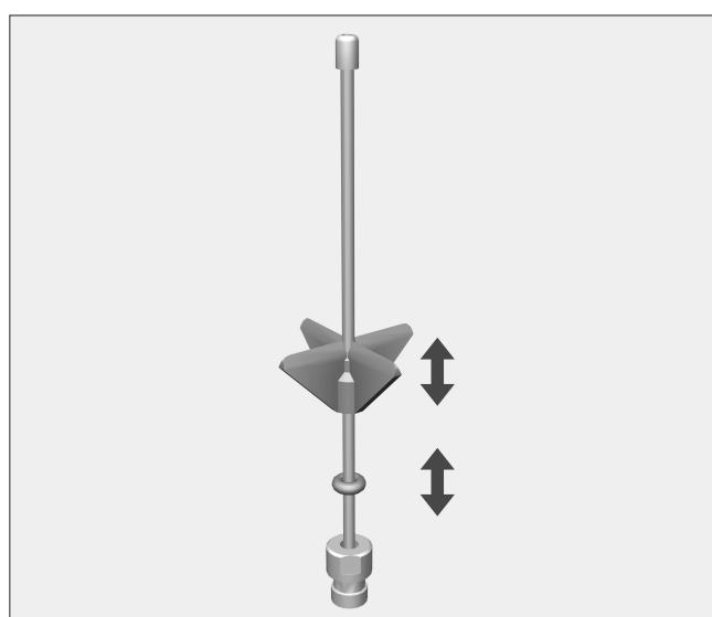
Para que la altura de los soportes de plástico sólo tenga que ajustarse una vez, el módulo inyector para los vidrios de laboratorio debería ser siempre del mismo tipo y tamaño.
