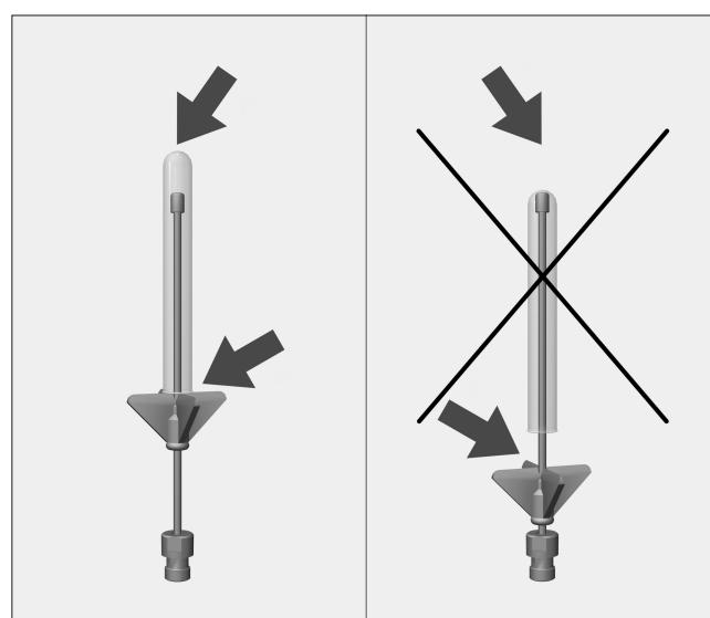
Caso a ponta do injector encoste à base do vidro, deslize o fixador para cima e fixe-o com a junta de borracha.
