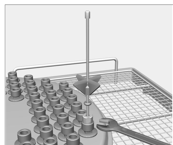
Ajuste con una llave de boca SW 9 las toberas de inyección que se hayan aflojado.
