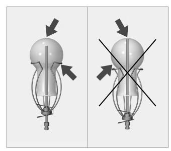
Caso a ponta do injector encoste à base do vidro, deslize o fixador para cima.
