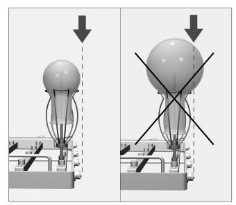
Los vidrios no deben sobresalir del borde del módulo inyector.
