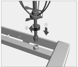
Aparafusar os injectores e fixa-los com a chave de bocas SW 9.
