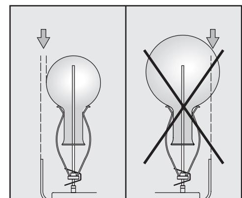
Glass må ikke stikke ut over kanten på injektorvognen.
