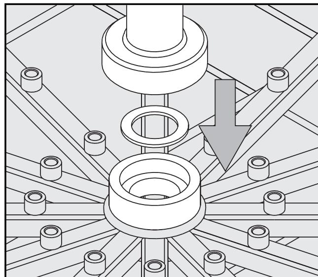
For enklere montering av vanntilførselsrøret kan du evt. skru ut enkelte injektordyser fra midten av overkurven.
