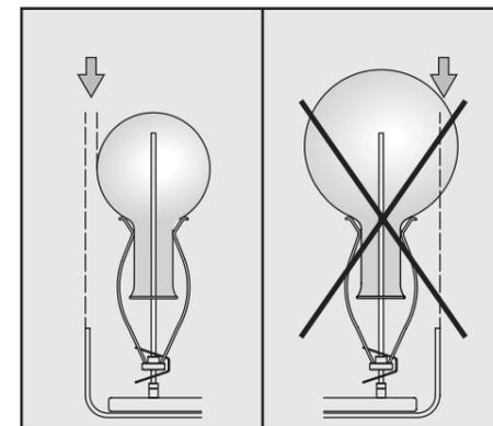
Glass må ikke stikke ut over kanten på injektorvognen.
