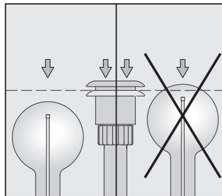
Glass må ikke stikke over vanntilførselsrøret (med nedtrykket adapter for vanntilførsel).
