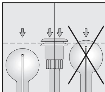
Glasen får inte skjuta ut över tilloppröret (med nedtryckt adapter för vattenförsörjning).
