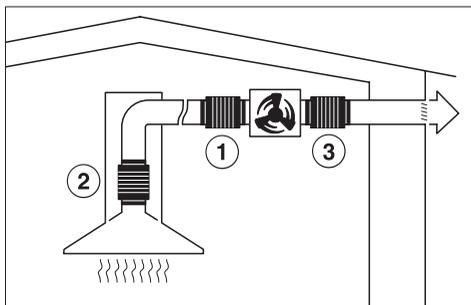
Afin de limiter au maximum les bruits de ventilation dans la cuisine, l'amortisseur de bruits doit être placé le plus près possible devant le moteur externe ①. Si la conduite d'évacuation est très longue, l'amortisseur de bruits doit être placé sur le raccord d'évacuation de la hotte ②.
