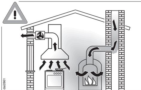
► En cas de fonctionnement simultané d'une hotte et d'un appareil de chauffage dépendant de l'air ambiant installés dans la même pièce ou zone d'aération, la prudence est de rigueur.
