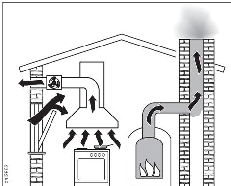
Cette dépression peut être obtenue si l'air nécessaire à la combustion peut circuler par des ouvertures, par exemple, dans les portes ou les fenêtres.
