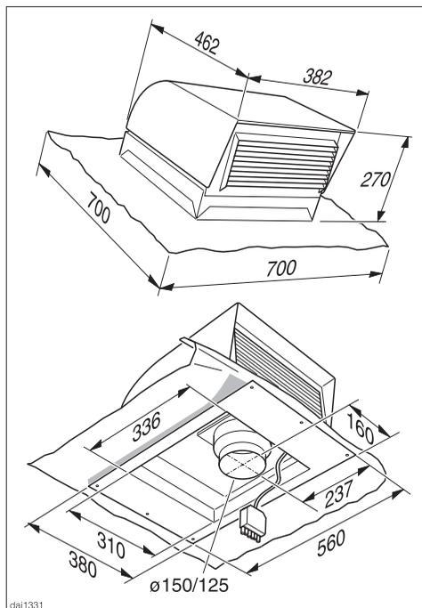
Le moteur de toit est prévu pour un montage sur des toits en briques, en tuiles, en ardoises ou en bardeaux. L'inclinaison du toit doit être d'au moins 22° pour éviter toute infiltration de pluie et de neige.
