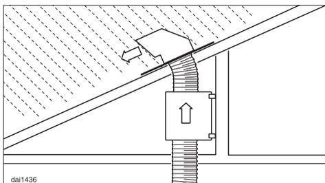
En cas de montage vertical du moteur et d'évacuation directe via le toit, il faut utiliser la conduite de toit DDF 125/150 ou prendre d'autres mesures pour faire en sorte que l'eau de pluie ne puisse pénétrer dans la conduite d'évacuation.
