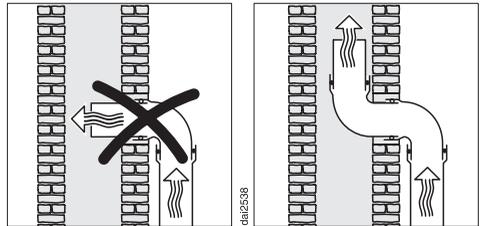
En cas d'évacuation dans une cheminée, dirigez le raccord dans le sens du flux d'air.
